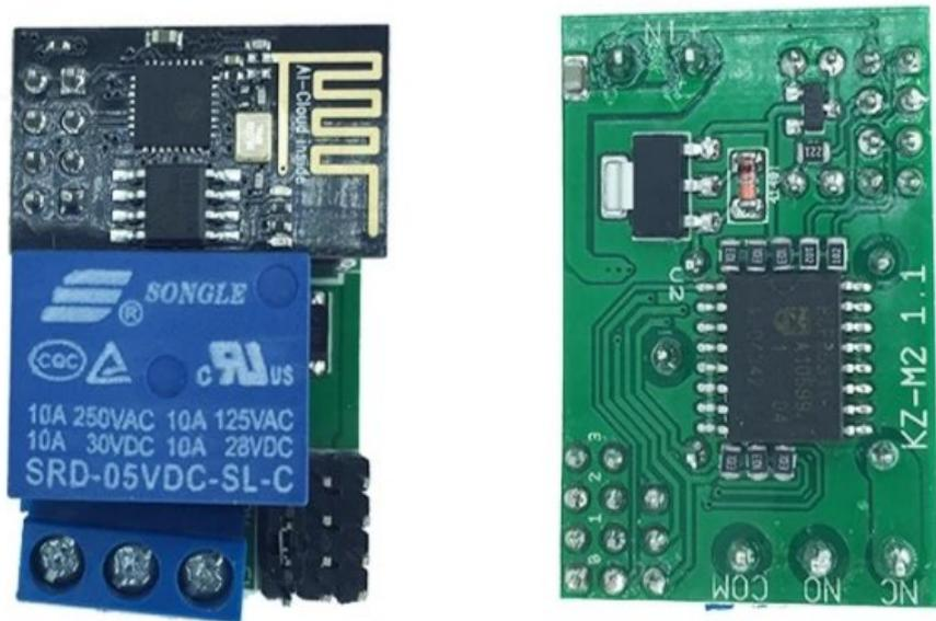
图 10 物联网控制器
