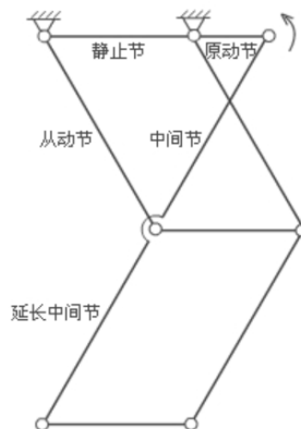
图3 切比雪夫连杆机构运动简图
